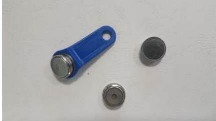
Figure 5. Sondes de température Thermotrack utilisées
